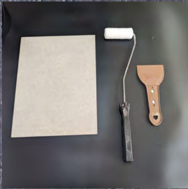
セメント系薄板、ローラー、ラバーベラ
